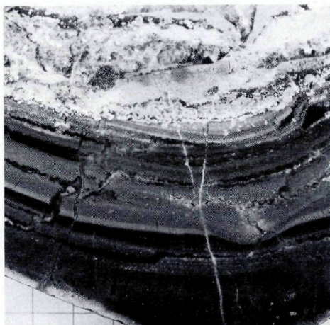
Abb. 6: Fluorit-Kalkfeinschichten (unten), nach syndiagenetischer Faltung an Erosionskontur überlagert von pseudomorph zu Hydrozinkit umgewandelten Zinkblendekörnern (weiß-grau) und derber Zinkblende (verschieden grau). In der unteren Bildhälfte einige syndiagenetisch sammelkristallisierte Fluoritaggregate (schwarz) parallel und schräg zur Feinschichtung. Großanschliff, Maßstab: cm-Papier.
